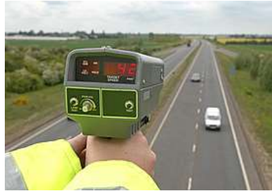
Pistola laser, pistola radar e conteggio manuale con rilevazioni di velocità puntuali
